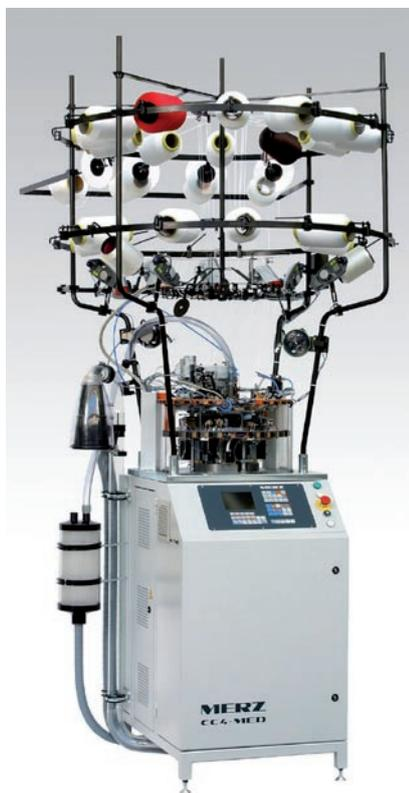
Abb. 1: Rundstrickmaschine
